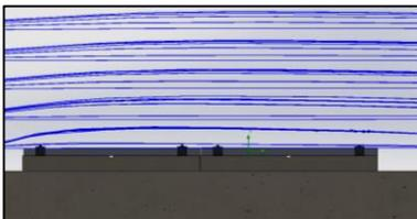
Simulación de cargas de viento en software especializado para garantizar resistencia.
